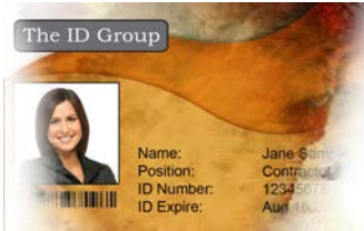
Zu helles Druckbild oder Fehlstellen an den Seiten
