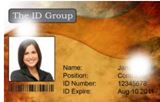
Unregelmäßige Fehlstellen im Druckbild
