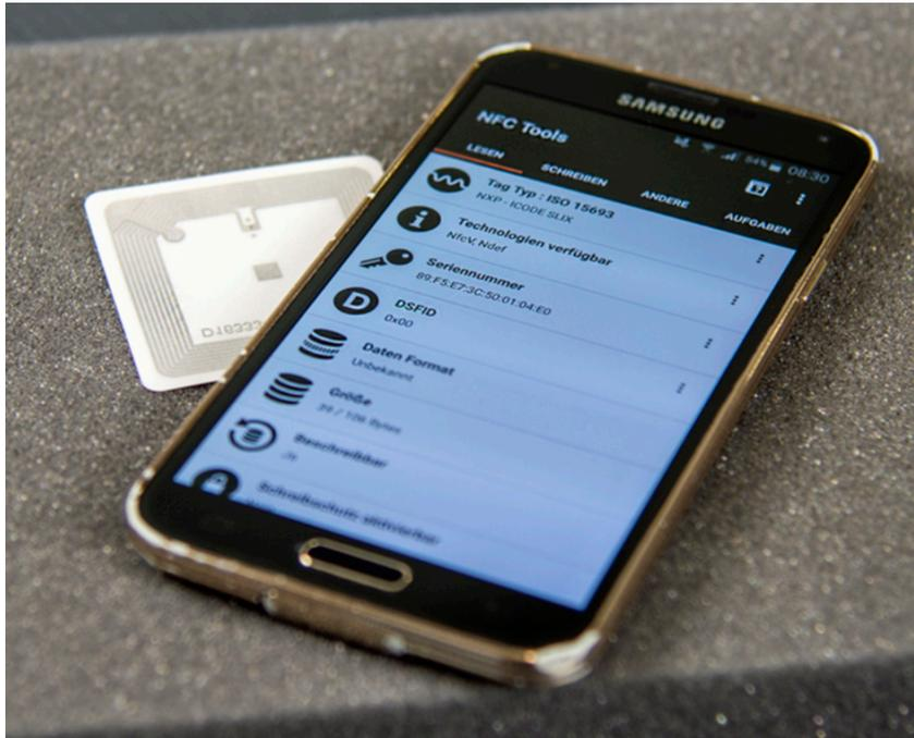
Wenn eine NFC-Etikette einen Web-Link enthält, genügt es, wenn Sie ein NFC-fähiges Smartphone nahe an das Etikett halten um automatisch die entsprechende Webseite zu öffnen.
